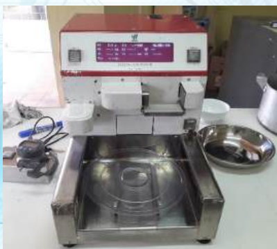
Hình 5. Máy phân tích trứng DET-6000.
